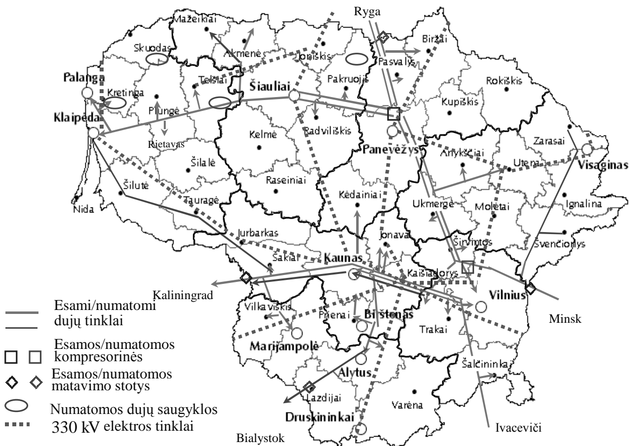
1 pav. Lietuvos elektros, dujų tinklų schemas ir teritorinis paskirstymas į zonas
