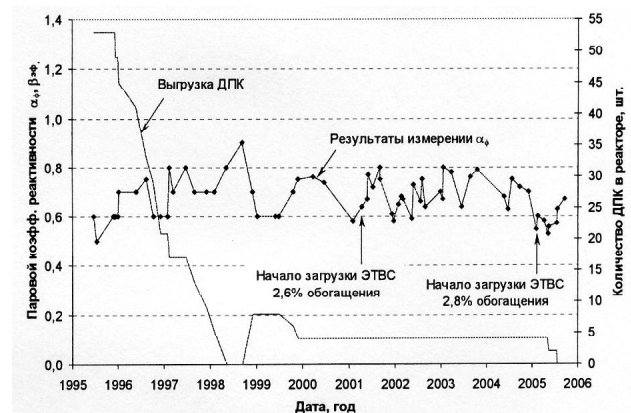
Рис. 4. Результаты измерений парового коэффициента реактивности на 2-ом энергоблоке в процессе внедрения уран-эрбиевого топлива и выгрузки ДПК
