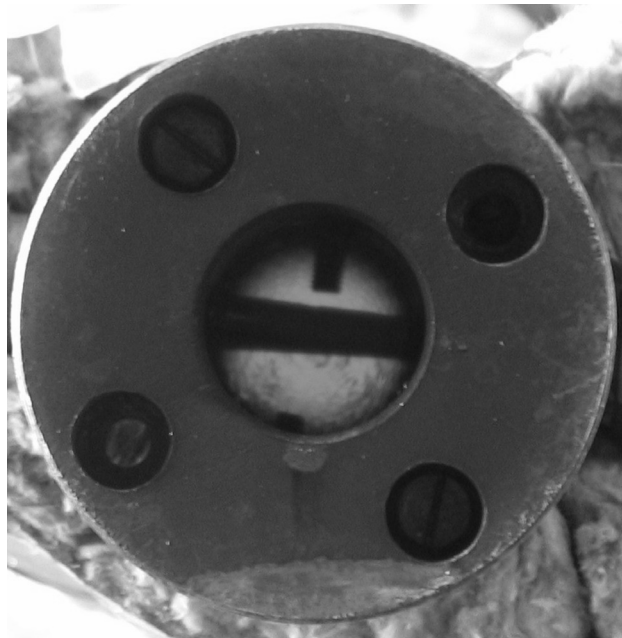
9 pav. Veikiantis KMR katalizinio degimo kameroje
