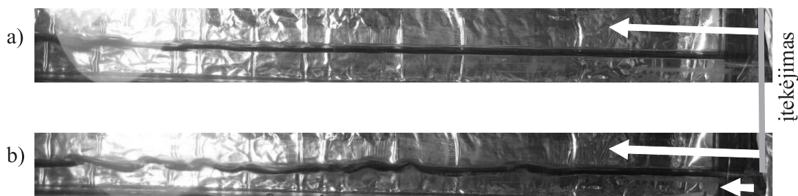
3 pav. Garo–vandens tarpfazinis paviršius. Be kondensacijos (a) ir su kondensacija (b). Garo greitis įtekėjime – 10 m/s
