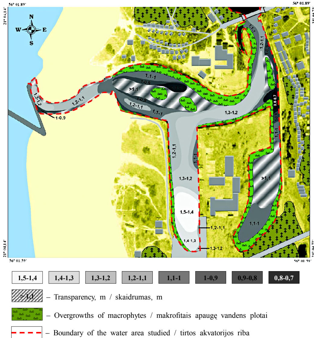
Fig. 4. Water transparency in the Šventoji port 4 pav. Šventosios uosto akvatorijos vandens skaidrumas
