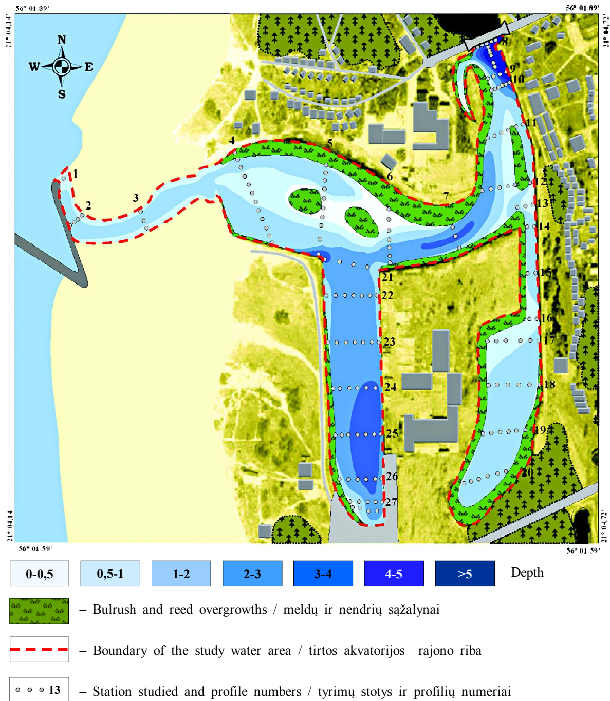
Fig. 3. Bathymetric scheme, study profiles and stations in the Šventoji port water basin 3 pav. Šventosios uosto akvatorijos batimetrinė schema, tyrimų pjūviai ir stotys
