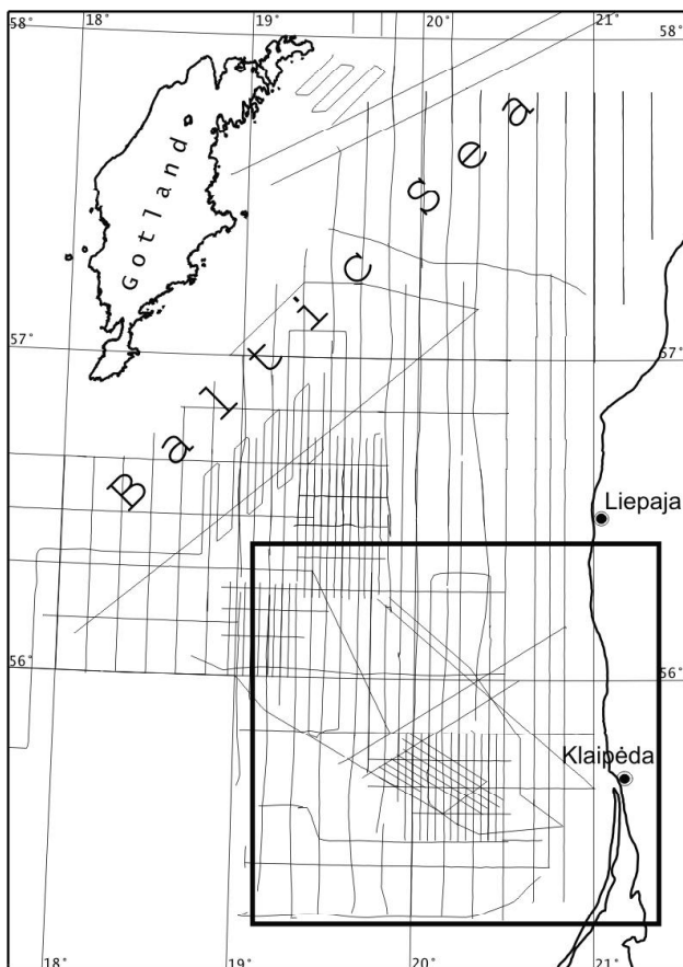
Fig. 1. Seismic reflection grid run during Lithuanian–Swedish surveys in 1993–1999. Solid square shows the study area 1 pav. Lietuvos ir Švedijos 1993–1999 m. ekspedicijos metu nustatytos seisminių profilių linijos
