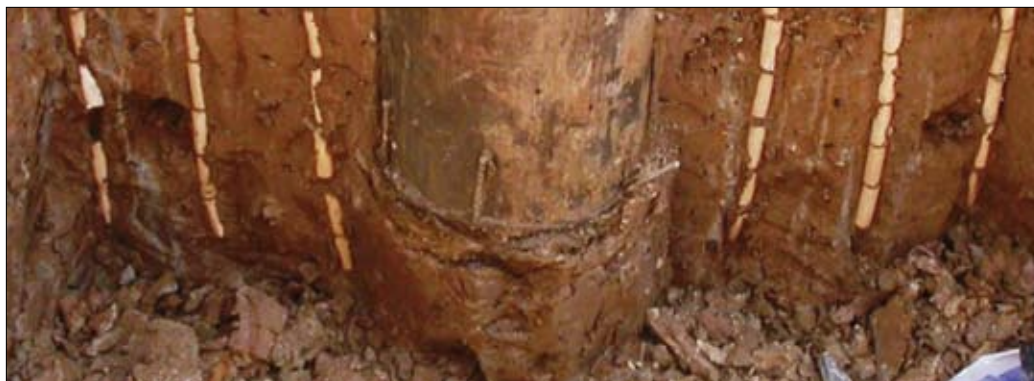
Fig. 9. Shift of the markers after pile driving 9 pav. Žymeklių polinkis po polio įgilinimo
