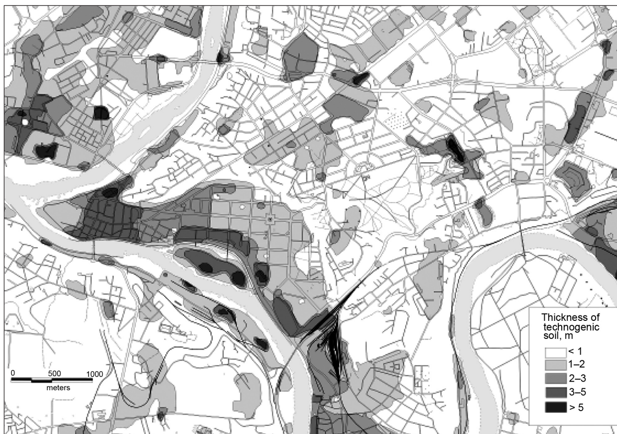
Fig. 1. Thickness of man-made soil in Kaunas (Paukštė, Mikulėnas, 2004)
