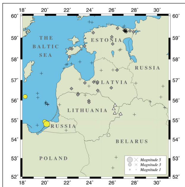
Fig. 3. Local seismic events recorded by the SMS of the Ignalina NPP during 1999–2009. Triangles correspond to seismic stations of the Ignalina NPP, grey diamonds to explosions in queries, circles to earthquakes, and crosses to explosion events 3 pav. Lokalus seisminiai įvykiai, užfiksuoti Ignalinos AE seisnologiniame tinkle 1999–2009 metais. Trikampiai – seisminės stotys, pilki rombai – sprogdinimai karjere, apskritimai – Žemės drebėjimai, kryžiai – sprogdinimai Baltijos jūroje
